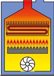
Котел должен комплектоваться отдельными каналами для отвода дымовых газов и подачи воздуха для горения
