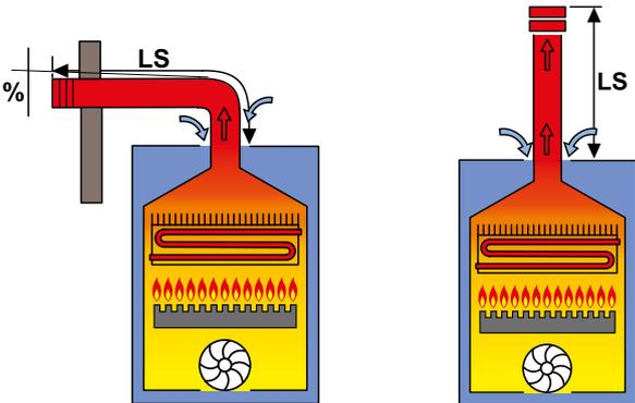
В данном типе подключения воздух для горения забирается непосредственно из помещения, где установлен котел
